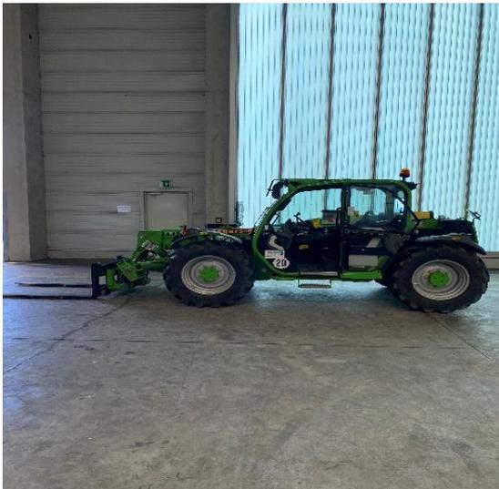
Der Teleskoplader wurde für den gesamten Mutterkonzern angeschafft und ist der Feuerwehr unterstellt. Da er nicht nur für feuerwehrdienstlichen Zwecke verwendet wird, ist er in seiner Werksfarbe verblieben. Benötigt wird er für die LFZ- Bergung sowie für Lastentransporte und vieles mehr. Ein Personenkorb sowie ein Schneeschild und eine Straßenbesenwalze sind im Jahr 2024 in der Anschaffung vorgesehen.
