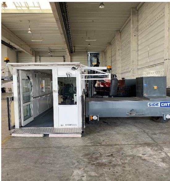
Der Ambulifter wird ausschließlich für den PRM- Service an den Passagiermaschinen eingesetzt, um Passagiere mit körperlichen Einschränkungen damit vom Terminal zum Flieger bzw. vom Flieger zum Terminal zu bringen.
